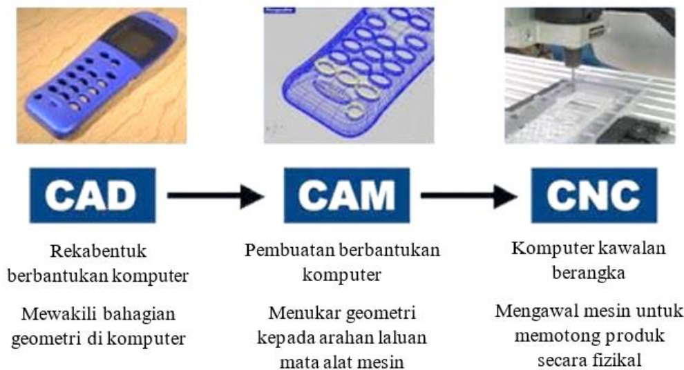
Rajah 3: Ringkasan perbezaan berkenaan CAD, CAM dan CNC.
