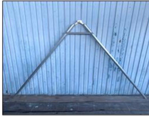
Rajah 2 : Sudut pada alat teleskopik tanaman segi tiga yang boleh dilaraskan untuk menetapkan jarak.
