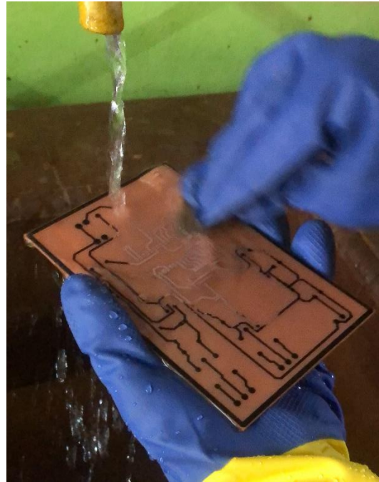
Rajah 6.6: Pembersihan Papan Litar Bercetak
