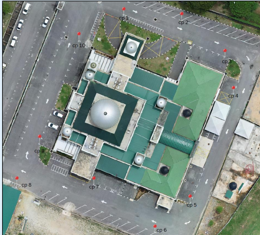
Rajah 8: Kedudukan titik-titik yang ditentukan pada ortofoto dibandingkan dengan titik-titik semakan atau Check Point (CP) yang dicerap menggunakan GNSS
