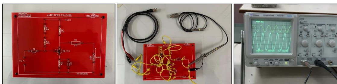
Rajah 1: Penyambungan dan pengujian AmpliTech Pro Trainer
