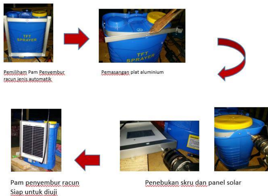
Rajah 2: Langkah Proses Pemasangan Alat Penyembur Bahan Kimia
