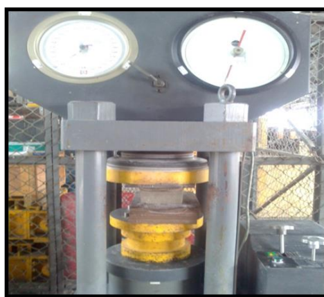
Rajah 6: Ujian Mampatan Bata
