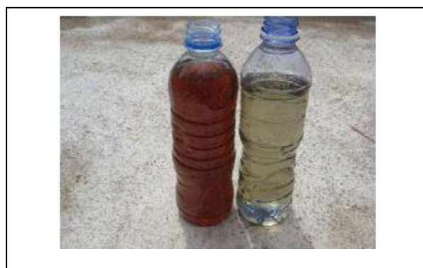
Rajah 9 : Efluen yang diambil sebelum pemasangan penapis (sebelah kiri) dan efluen yang diambil selepas pemasangan penapis (sebelah kanan)
