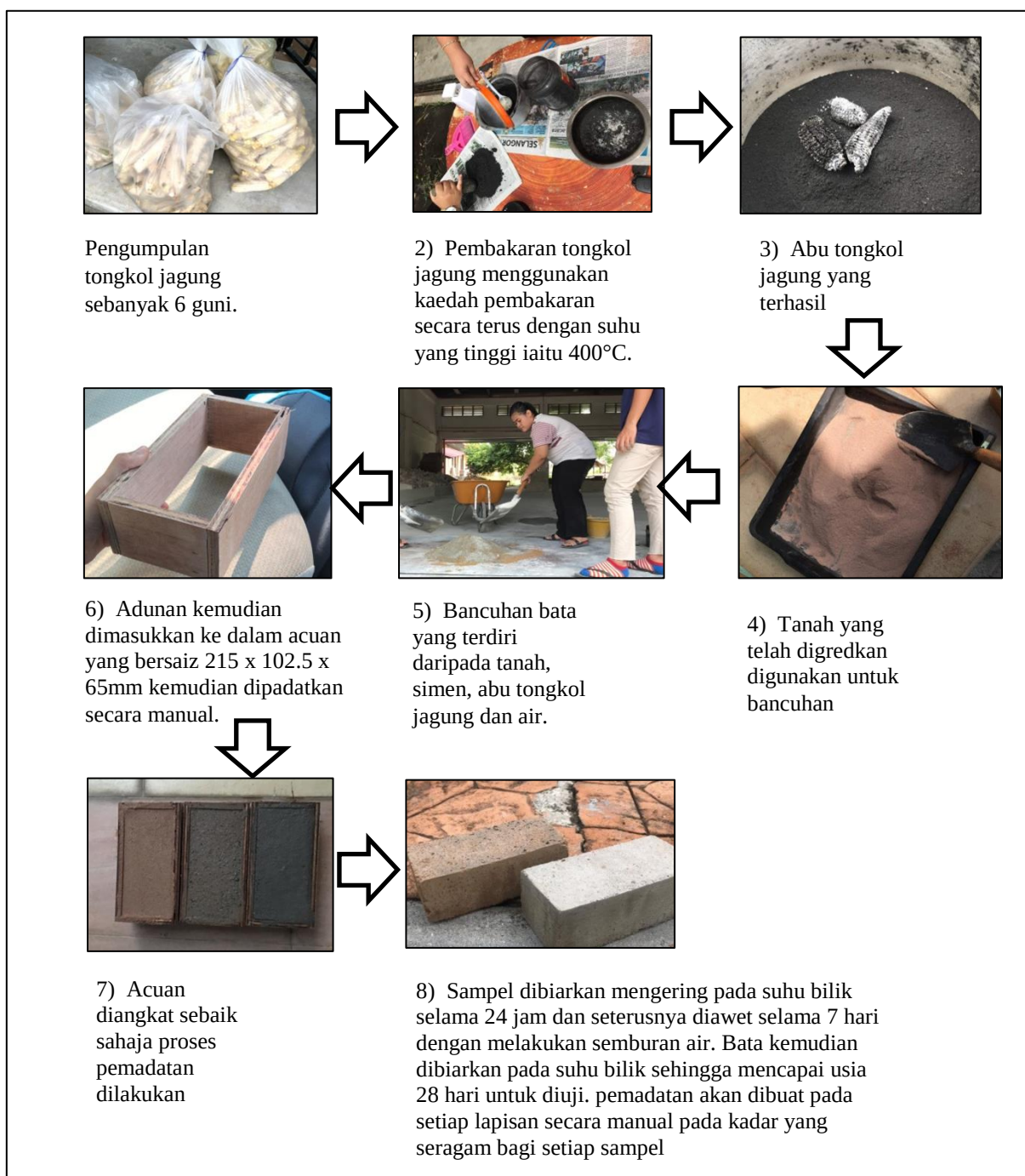
Rajah 3: Proses Penyediaan Bahan dan Pembuatan Bata
