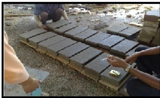
Rajah 5: Proses Mengawet Bata
