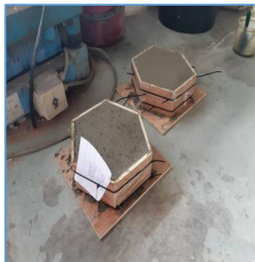
Rajah 7: Campuran yang telah dimasukkan ke dalam kotak acuan 'interlocking block'
