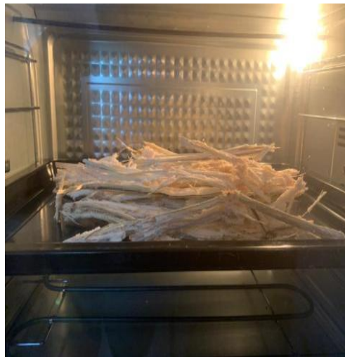
Rajah 3.2 Proses pengeringan hampas tebu menggunakan oven
