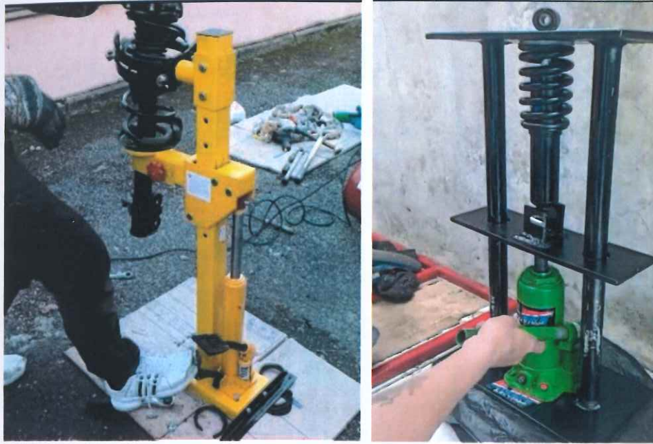
Rajah 2.4. Contoh proses kerja yang menggunakan alat jek hidraulik.
