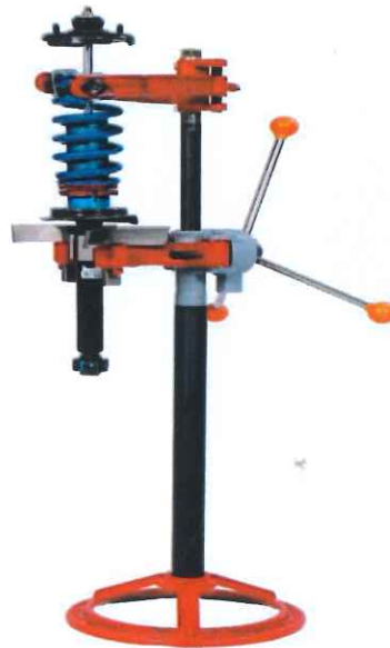
Rajah 2.5. Contoh alatan pemampatan absorber yang menggunakan kaedah putaran mekanikal.
