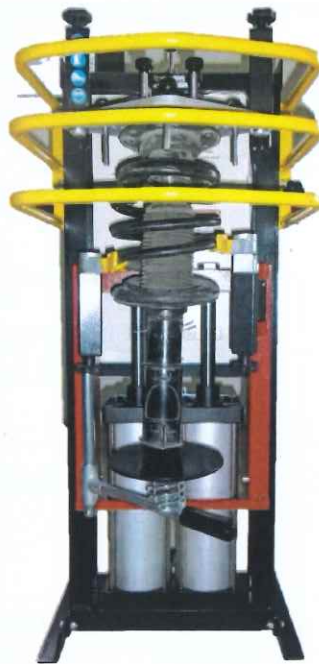
Rajah 2.6. Contoh alatan pemampatan absorber yang menggunakan kaedah pneumatik.
