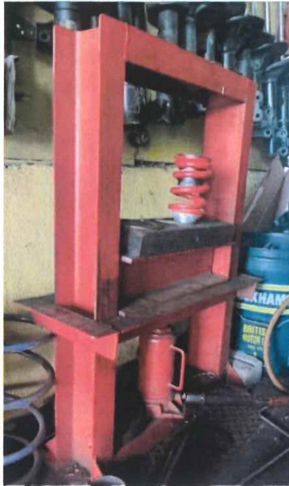
Rajah 2.2. Contoh alat yang digunakan untuk memampatkan spring absorber di lokasi tersebut.
