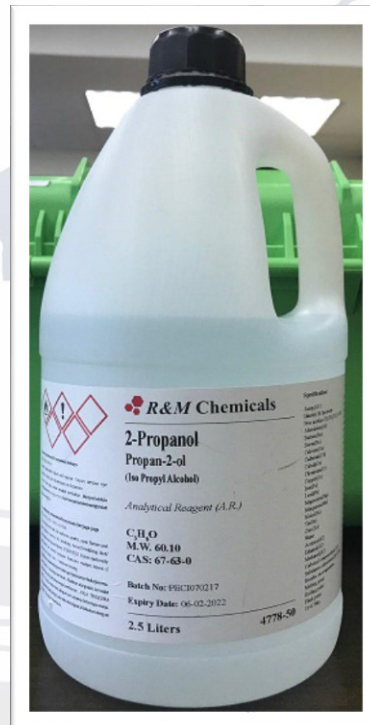
Rajah 3: Alkohol – digunakan bersama tisu untuk membersihkan core fiber optic
