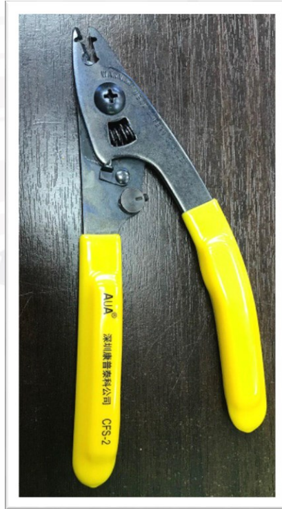
Rajah 4: Stripper (Pemotong Kabel) – Digunakan Untuk Memotong Perlindung Kabel Fiber Optik
