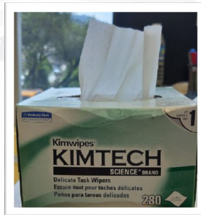
Rajah 2: Tisu Khas Yang Digunakan Untuk Membersihkan Core Fiber Optic
