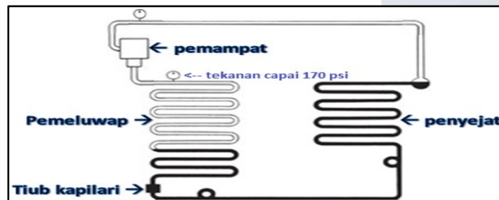
Rajah 2 : Skematik Kandungan Bahan Pendingin Selepas Kerja Pembaikan Yang Tidak Betul
