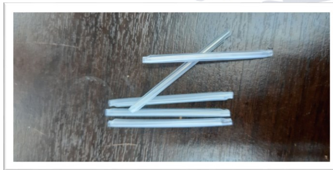
Rajah 5: Protection Sleeve – Pelindungan Kabel Fiber Optik Yang Telah Disambung
