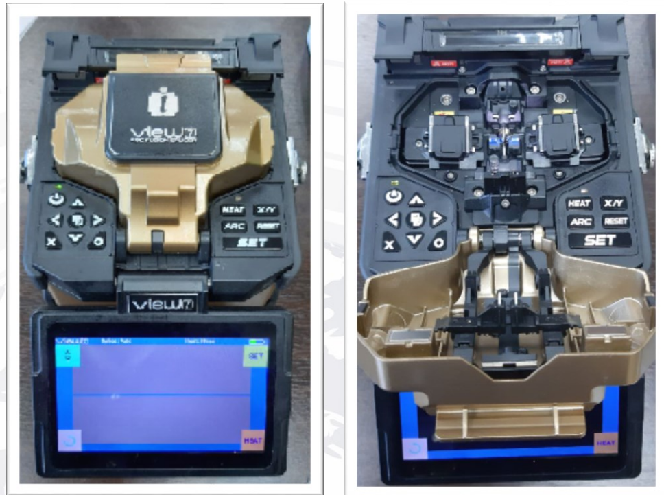
Rajah 7: Fusion Splicer – Menyambungkan Dua Core Fiber Optik Dengan Menggunakan Proses Pemanasan
