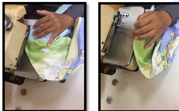
Rajah 9: Setiap cantuman sisi pepenjur kain cadar dijahit menggunakan mesin jahit tepi
