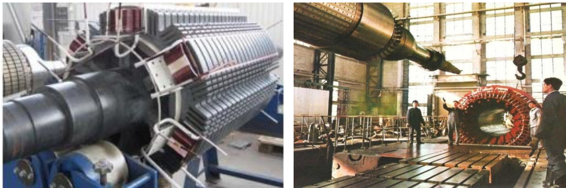
Rajah 4. 16: contoh gambar pemegun jenis ( non salient pole/ Cylindrical pole )
