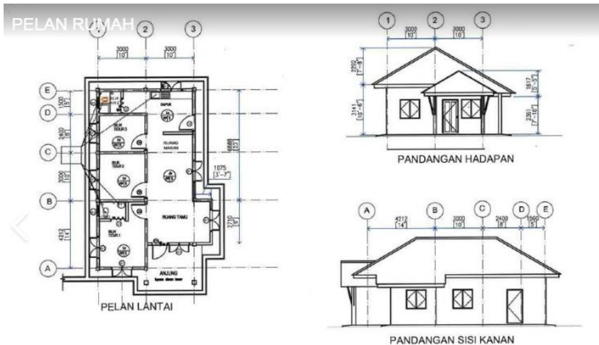
Rajah 83: Menunjukkan pelan lantai kedudukan tingkap
