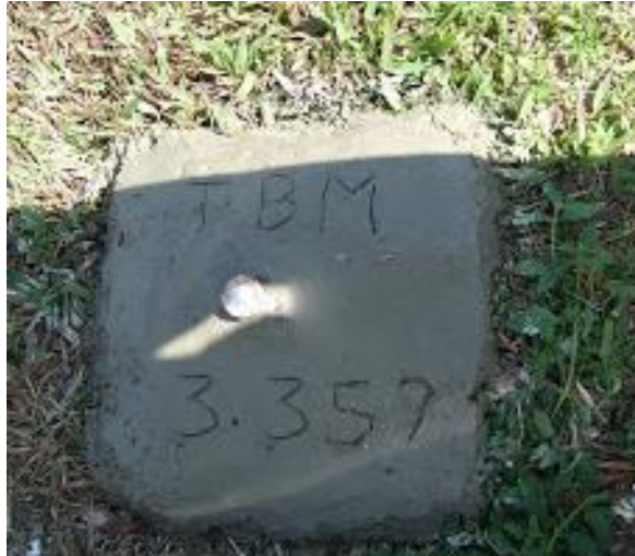
RAJAH 19: Contoh aras TBM baharu di tapak bina
