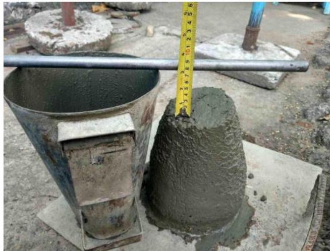
Rajah 7: Ujian runtuh sebenar di tapak bina
