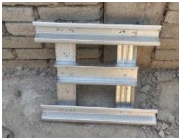
Rajah 76: Contoh alatan yang digunakan untuk memasang batten
