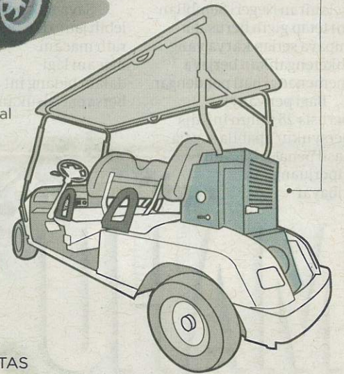
Tangki gas hidrogen
