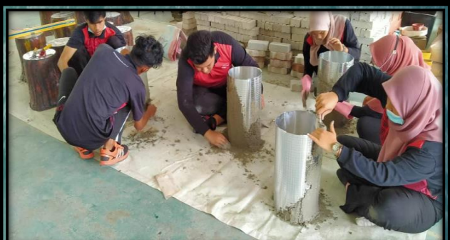
kerja penampalan bancuhan simen pada acuan
