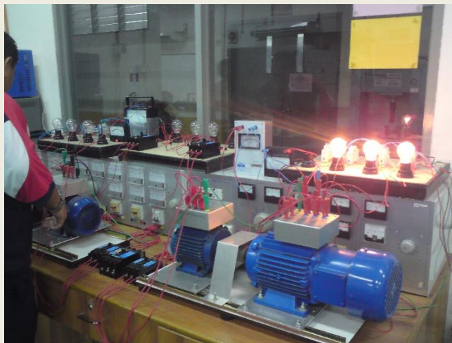
Rajah 3.3.2.1.1 : Membuat Pengujian Penjana Yang Kedua
