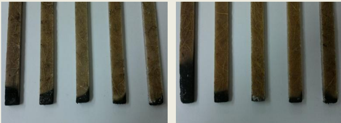
Rajah 7: Sampel Komposit UPR/Kepingan SKTT (kiri) dan Sampel Komposit UPR/Kepingan SKAS (kanan) selepas Ujian Kerintangan Api bagi Pencirian Had Pembakaran
