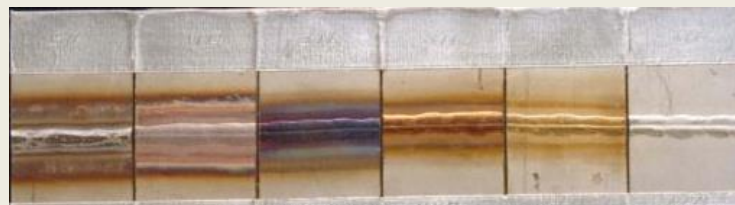
Rajah 1: Warna Haba Pada Sambungan Kimpalan Keluli Tahan Karat
