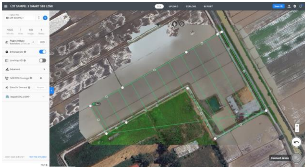
Rajah 5: Paparan Perancangan Penerbangan Menggunakan Dronedeploy Untuk Plot 01
