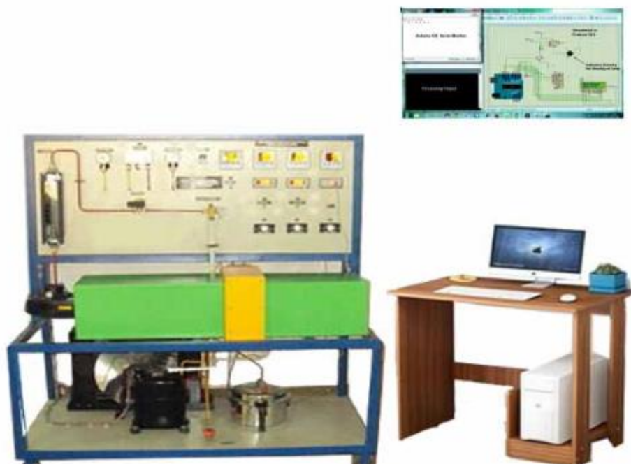
Rajah 2.2: Contoh Kit pembelajaran yang terdapat di pasaran (diambil dari https://sunlabtech.com/mechanical-engineering-lab-equipment/refrigeration-and-air-conditioning-lab-equipment/ pada 2 Januari 2024)
