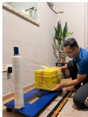
Rajah 2: Demonstrasi cara penggunaan Mesin Semi-Automatic Spinning Wrapping
