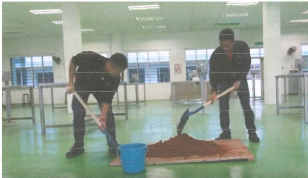
Rajah 1.2. Proses campuran pasir secara manual menggunakan skop.
