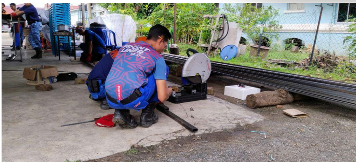
Rajah 10 Kursus Kimpalan Arka (Pemotongan Bahan Mentah Garaj).
